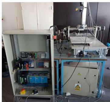
Sistem de deplasare controlată pe 3 axe și blocul de comandă
